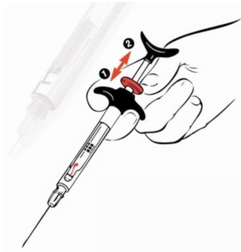
Рис. Схема и принцип работы шприца с пассивной самоаспирацией
